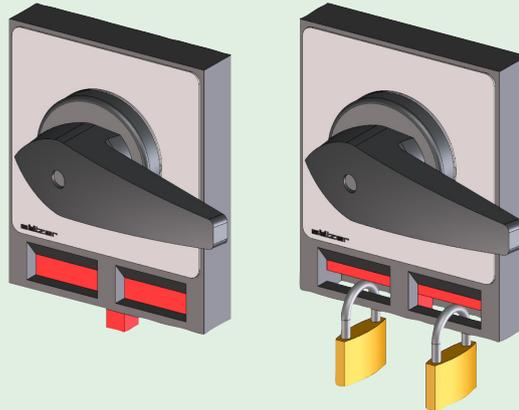
Roter Sperrschieber in der Ausgangslage: Schaltstellung kann geändert werden
